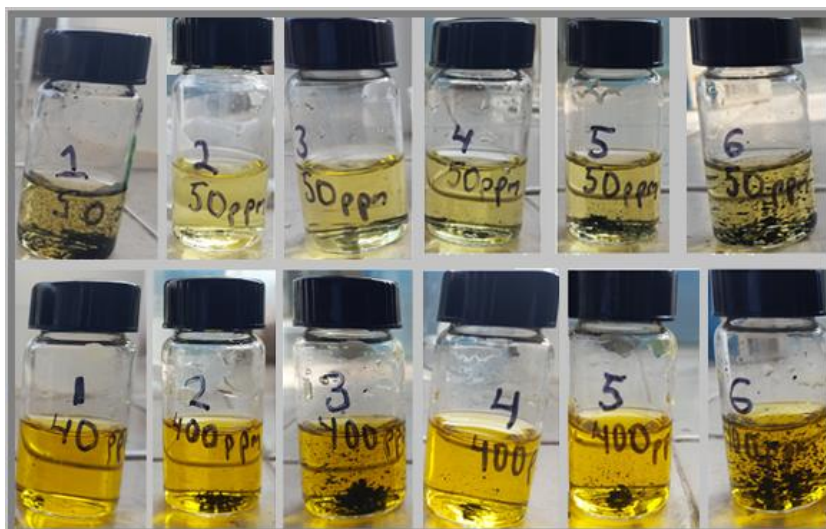
Figura 75. Compuestos CNTx-PIX en contacto con soluciones de Cr (VI).
