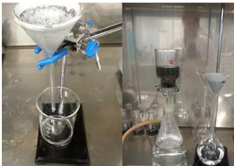
Figura 23. Filtración y lavado de los nanotubos de carbono
