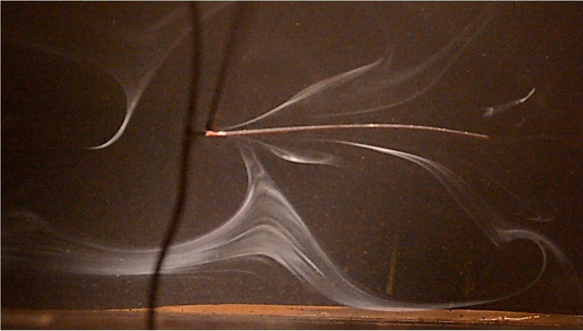
Figura 2.11: Foto del flujo interaccionando con la placa. Las regiones blancas corresponden al óxido de estaño. Estas regiones delimitan las regiones oscuras donde se encuentran los vórtices. La placa flexible corresponde a la línea roja. La raya vertical más oscura corresponde a la sombra de la varilla que mantiene el eje de la placa.
