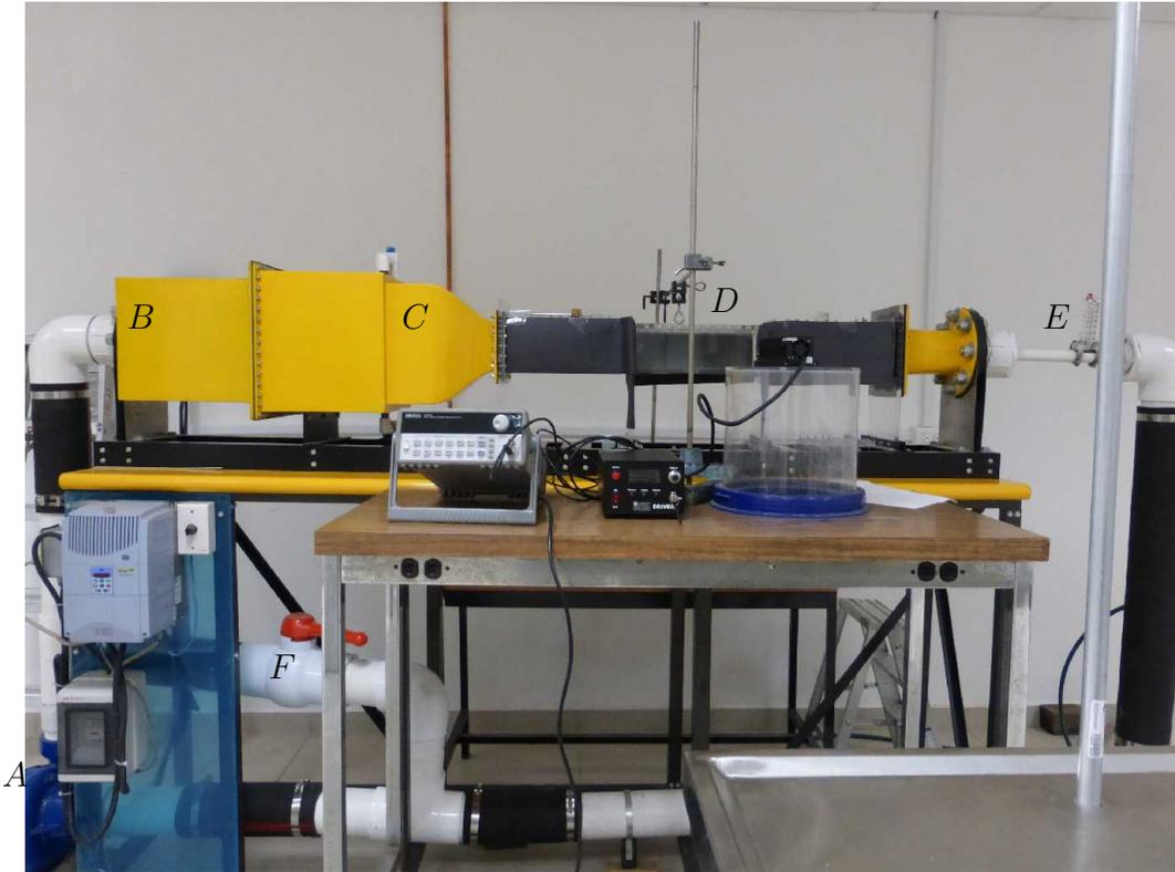
Figura 2.1: Canal de agua utilizado en el presente trabajo. (A) bomba trifásica, (B) divergente, (C) convergente, (D) sección de pruebas, (E) flujómetro, (F) by-pass.
