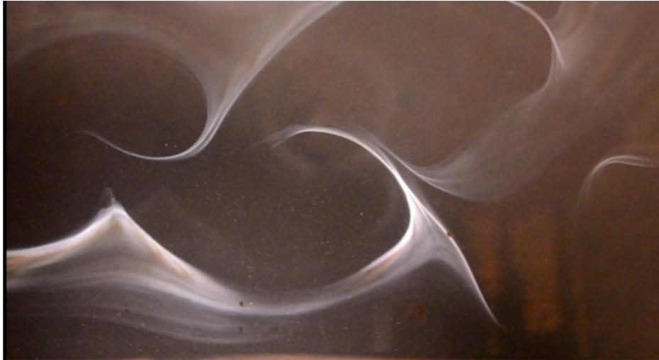
Figura 2.8: Vórtices von Kármán visualizados por medio de la precipitación de óxido de estaño.
