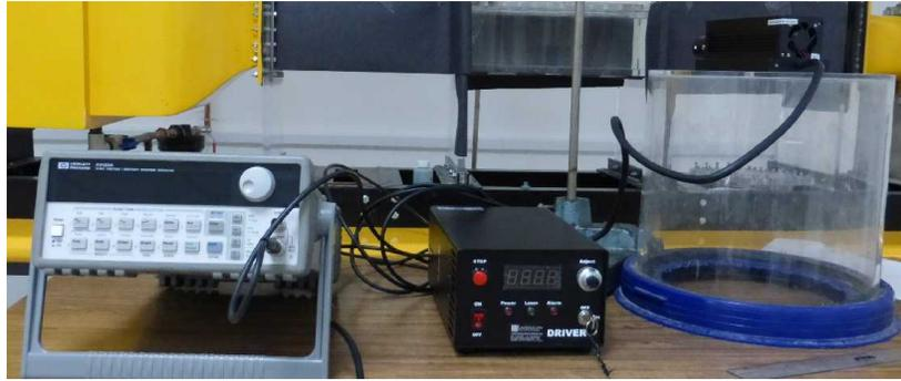
Figura 2.5: Generador de pulsos en el lado izquierdo, el controlador del láser y el láser del lado derecho.
