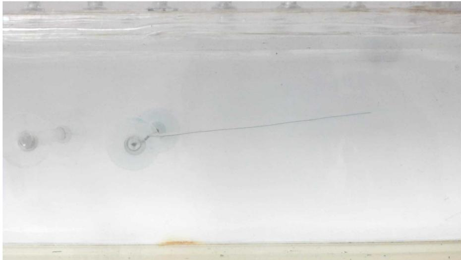
Figura 2.9: Foto que muestra la placa flexible amarrada horizontalmente en el canal de agua y se observa en la imagen como la línea negra.
