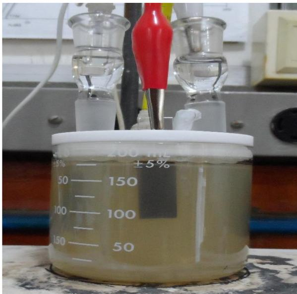
Figura 22 Depósito de SnS en una celda de tres electrodos.
