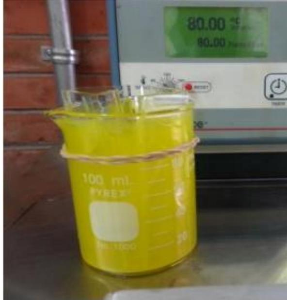
Figura 33 Baño químico de CdS con estructura hexagonal.
