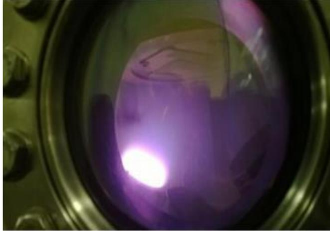
Figura 35 Plasma creado por la pulverización del ZnO:Al.
